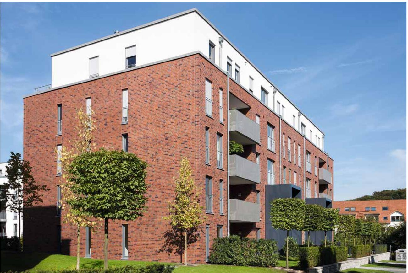
Fassaden mit Klinkerriemchen sind optisch nicht von Vollmauerwerk zu unterscheiden.
